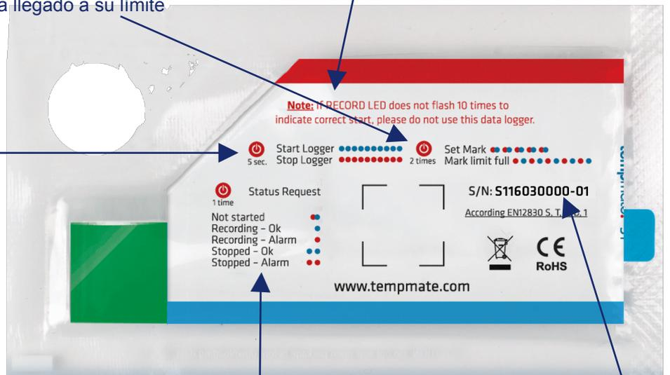
Recordatorio de función del Data Logger al presionar el botón Start / Stop 1 vez dependiendo de la combinación de colores de los Leds informa si el Data Logger no está activado, si está activado correctamente, si ha registrado una alarma, si está parado correctamente o si está fuera de límites de alarma
